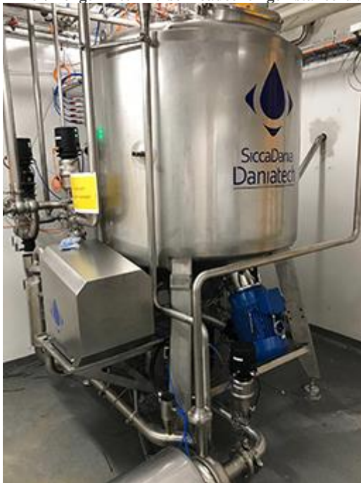
Mixer/menger met Eilersen loadcellen geïnstalleerd bij biotech-klant
